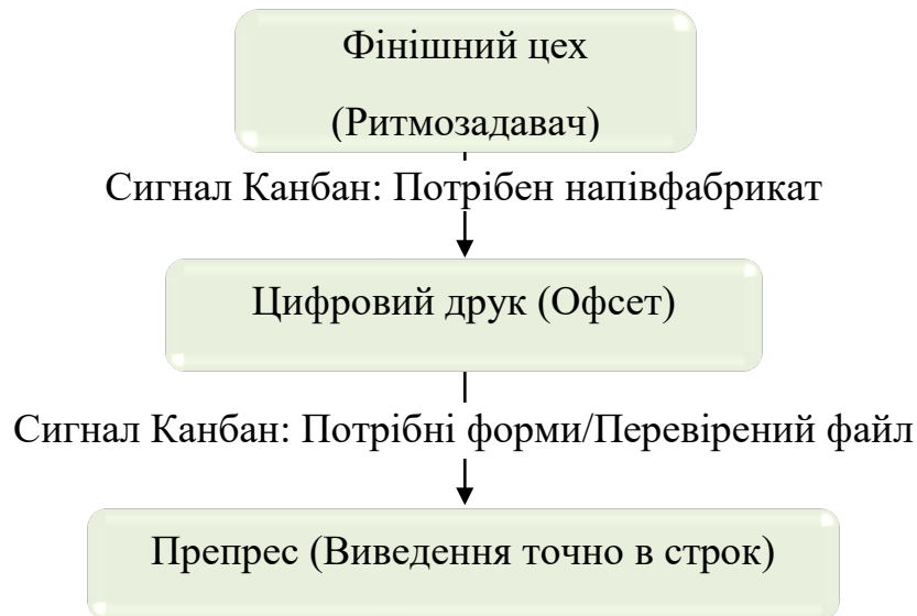
Рис. 3.5. Логістична схема управління потоком створення цінності в друкарні за принципом зворотного зв'язку
